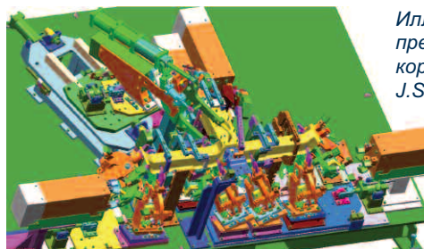
Сварочное приспособление с фиксаторами и сварочными горелками для сборочного участка в автомобилестроении.
