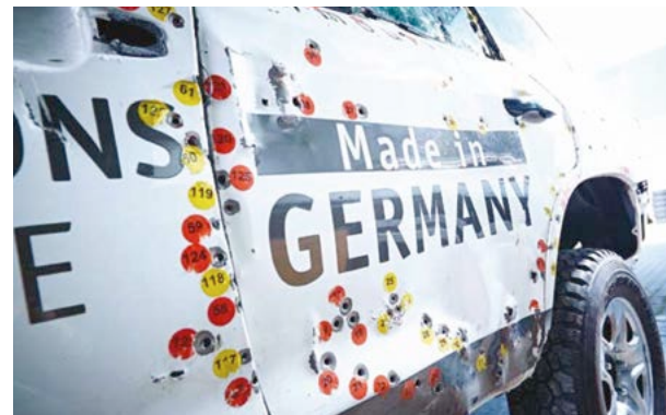
Beschussprüfung eines von Farmingtons Automotive ausgerüsteten Toyotas, erforderlich für die Zertifizierung durch staatliche Beschussämter Bildrechte: Farmingtons Automotive
