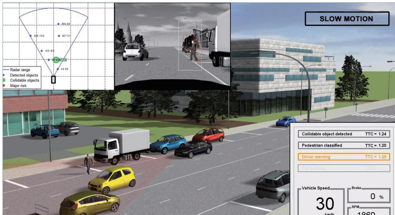
持到高频电磁雷达模型和传感器技术开发的基于物理场的摄像头模型。热分析工具还可让工程师支持车辆传感器设计和传感器集成。
