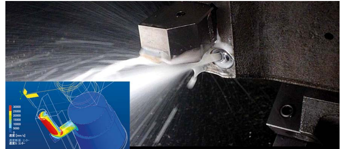
三菱材料公司使用 Simcenter FLOEFD 设计刀具的液冷喷嘴
