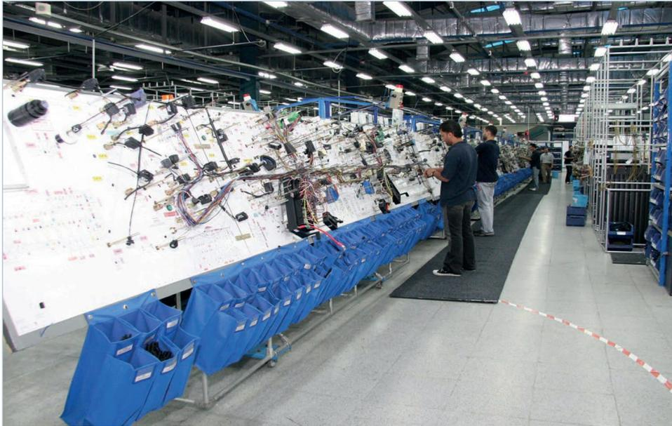
图 5：该工装提供线束的全尺寸图，以帮助制造
