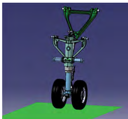
使用 Simcenter 3D 建立的参数化起落架仿真模型。
