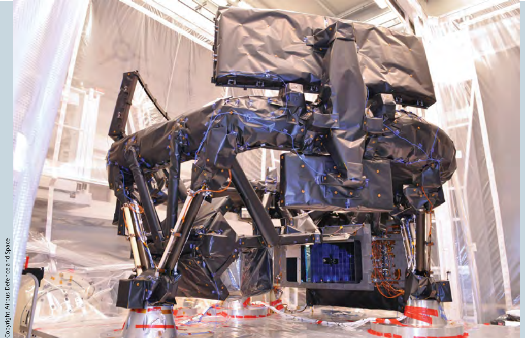
空中客车防务与航天公司在法国图卢兹试验中心用于环境试验的 Gaia 卫星模块装置
