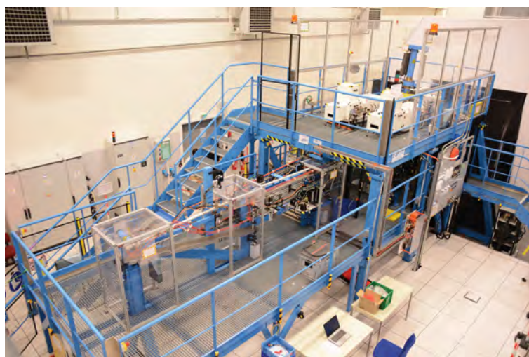
法国马里尼亚纳空客直升机研发中心的空中客车 H160 虚拟铁鸟测试设施。
