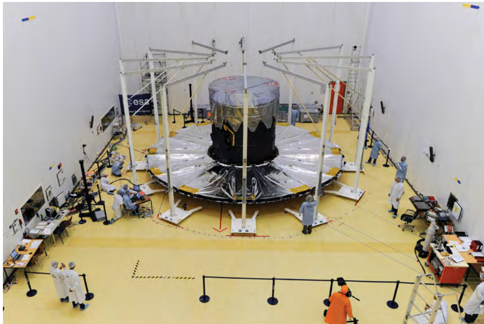
Gaia 可展开遮阳罩 (DSA) 融合到卫星和图卢兹进行的部署试验中。
