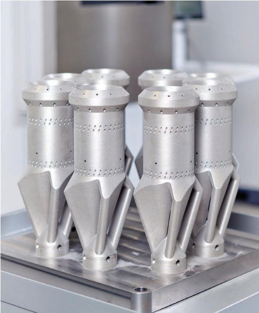
Рис. 5. Горелки газовой турбины, изготовленные методом 3D-печати
