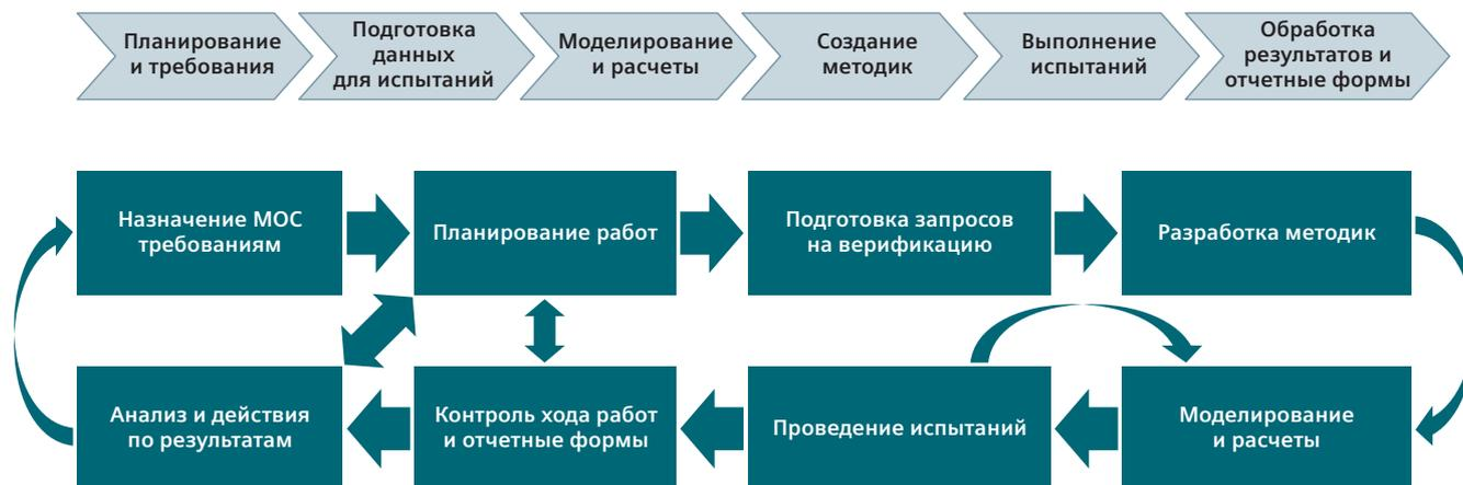
сертификации воздушного судна должен начинаться с ранних этапов проектирования, чтобы обеспечить прослеживаемость всего рабочего цикла и четкое выполнение всех предъявляемых требований, а также выявить ошибки и проблемы несоответствия еще на ранних этапах процесса. Применение новейших цифровых технологий позволяет сэкономить и ускорить разработку современных воздушных судов за счет автоматизации заметной доли расчетов и сертификационных испытаний.
