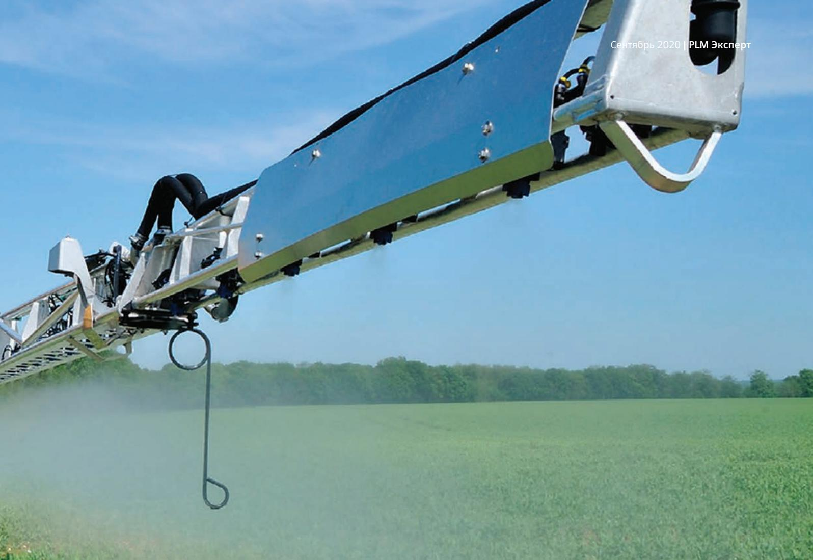
которое автоматически генерирует графики критериев модальной достоверности с цветовой кодировкой, которые позволяют понять, где есть расхождение. Увидев небольшое несоответствие, специалисты Siemens внесли изменения в КЭ-модель, чтобы включить в расчет массу жидкости в крыле штанги, а также массу пар пружинного демпфера в подвеске штанги. Эти изменения позволили получить более точные результаты.
