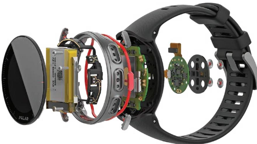
Состоящие из более 500 компонентов часы Polar Vantage спроектированы с помощью интегрированных инструментов Siemens Digital Industries Software
