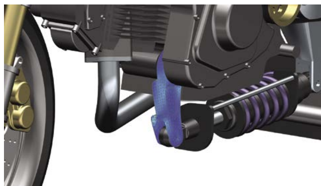
Проектирование гибких компонентов в моделировании кинематики позволяет учитывать усталостную долговечность.
