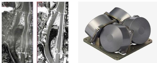
Рис. 17. Слева: искажение изображения, вызванное микровибрациями<sup>12</sup>. Справа: реактивные колеса для управления положением.
