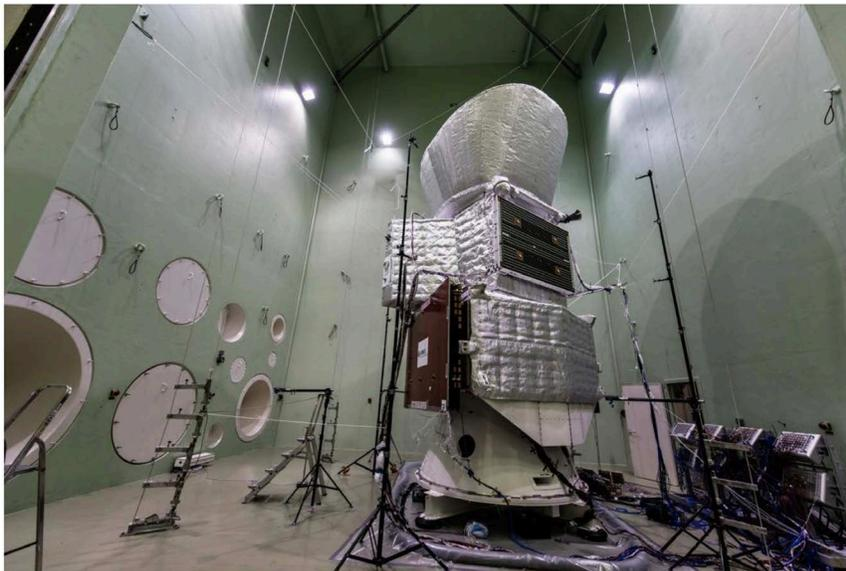
Рис. 9. Испытание методом акустического возбуждения реверберационного поля в Европейском космическом агентстве (ЕКА).
