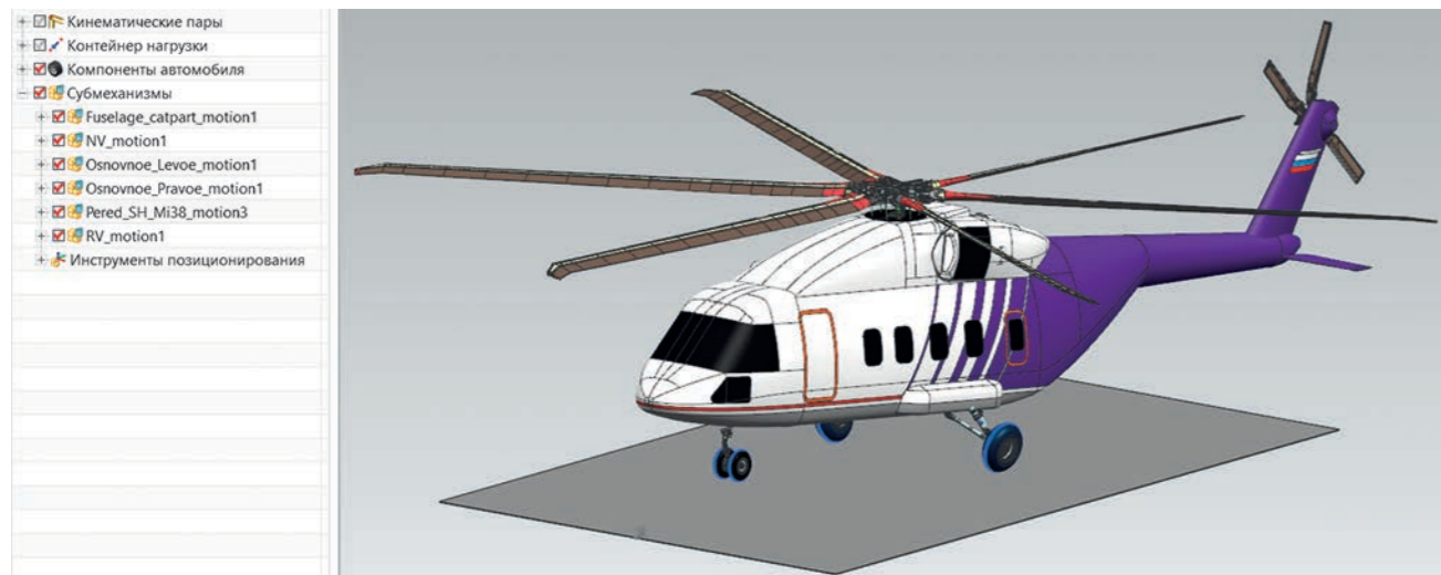
Рисунок 5. Модель посадки вертолета с твердотельным фюзеляжем
