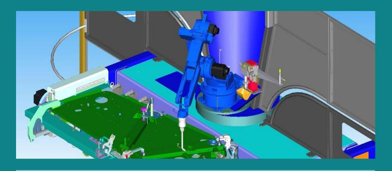
Проверка сварочных процессов и подготовка УП
