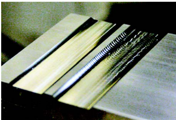
Рис. 1. Два реза, демонстрирующие стабильные условия механообработки и последствия вибрации.
