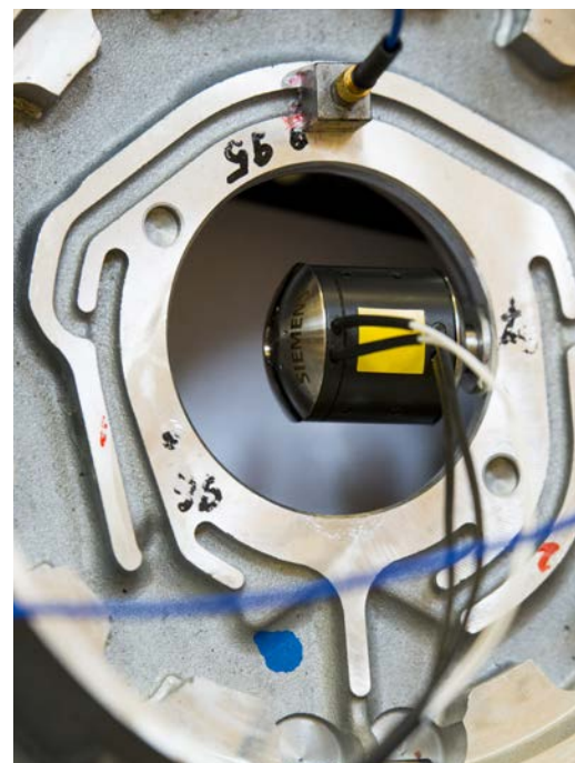
Миниатюрные самоцентрируемые вибровозбудители Simcenter QSource позволяют быстро и точно получать передаточные функции при установке в любой точке конструкции.
