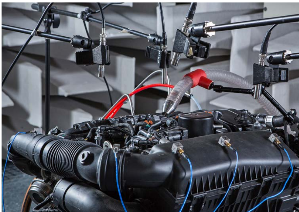
Надежное и эффективное определение акустических передаточных функций при помощи среднечастотных излучателей Simcenter QSource.
