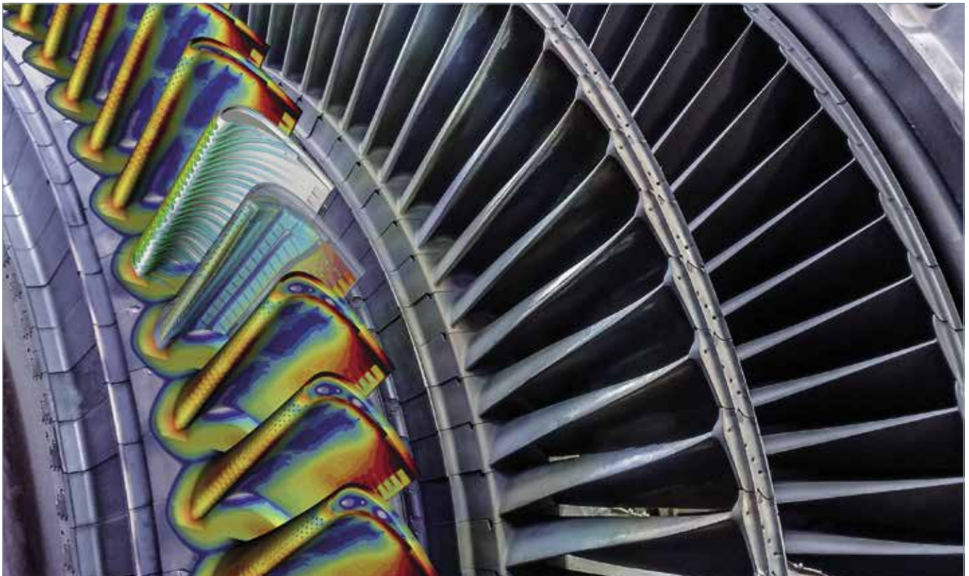
Analiza sprzężonej wymiany i wydajności chłodzenia turbiny gazowej.
