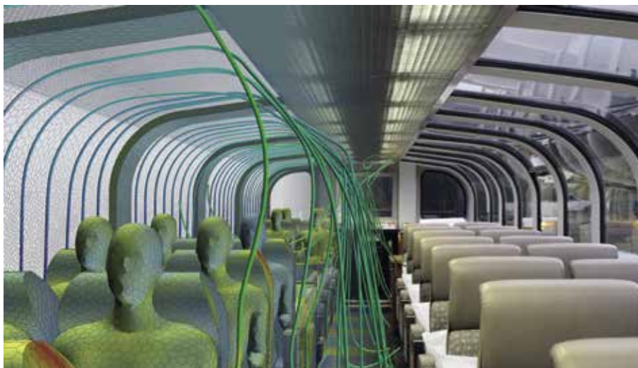
Bliźniak cyfrowy kabiny pociągu opracowanej przez Stadler Altenrhein AG za pomocą STAR-CCM+ w celu poprawy komfortu cieplnego pasażerów.
