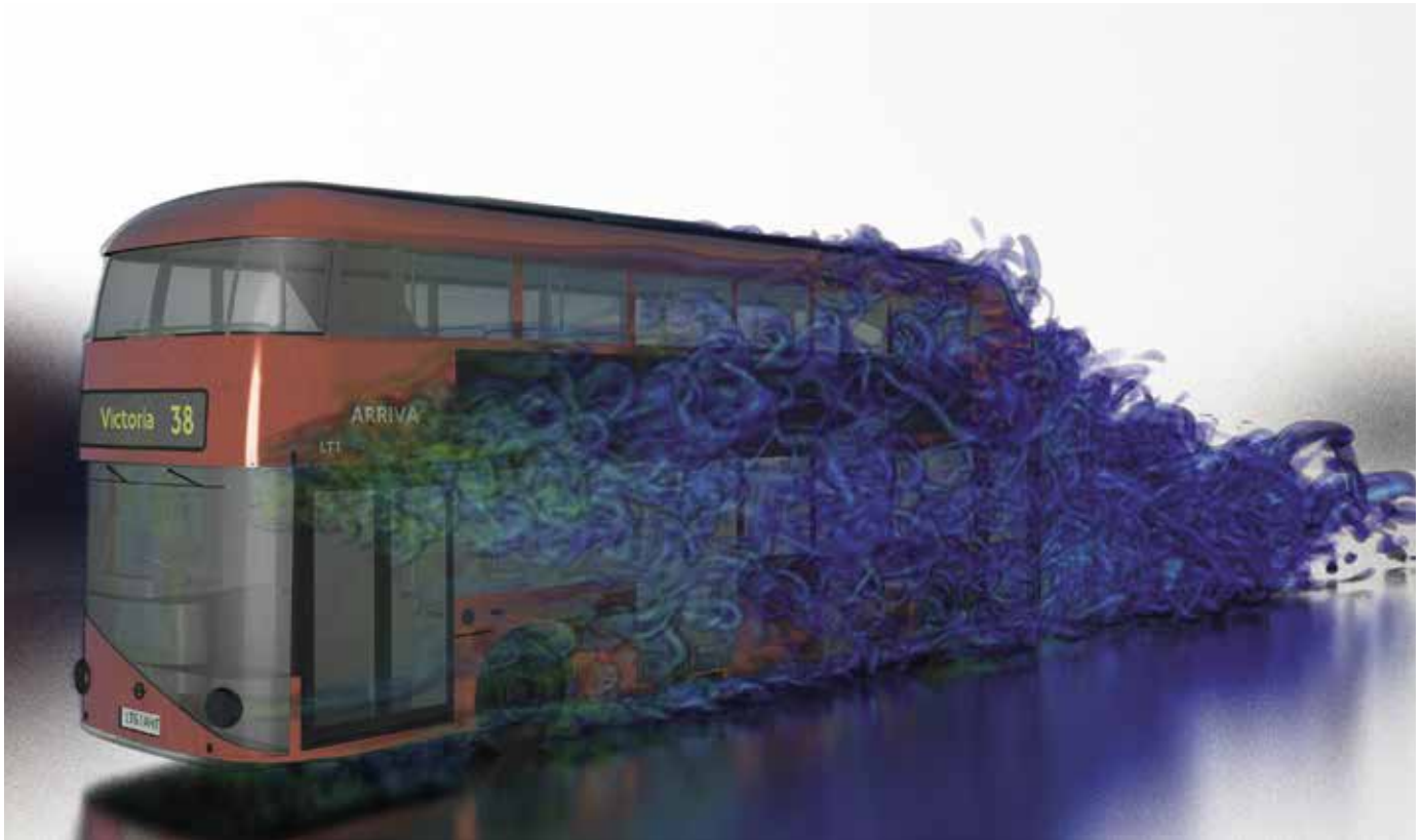
Aerodynamiczna analiza projektu nowego londyńskiego autobusu za pomocą STAR-CCM+.
