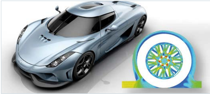
Symulacja chłodzenia hamulców samochodu sportowego z wykorzystaniem rozwiązania CFD osadzonego w systemie CAD
