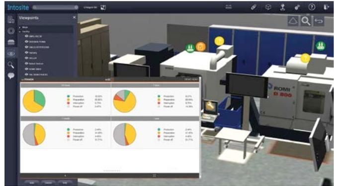
Intosite는 전 세계 가상 공장의 스마트맵 내비게이션을 제공하는 클라우드 기반 애플리케이션으로서, 위 그림과 같이 기계 태그로 액세스하는 생산 실적표 등 핵심 제조 데이터를 활용해 협업을 지원합니다.
