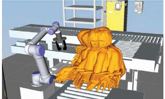
Siemens PLM Software는 안전 관련 규정 준수를 위해 작업과 환경상의 위험성을 더욱 정확하게 평가하기 위한 목적으로 Tecnomatix Process Simulate 소프트웨어를 탑재한 디지털 트윈을 이용해 인간-로봇 상호작용을 가상으로 모델링하고 계획하는 방법을 연구하고 있습니다.
