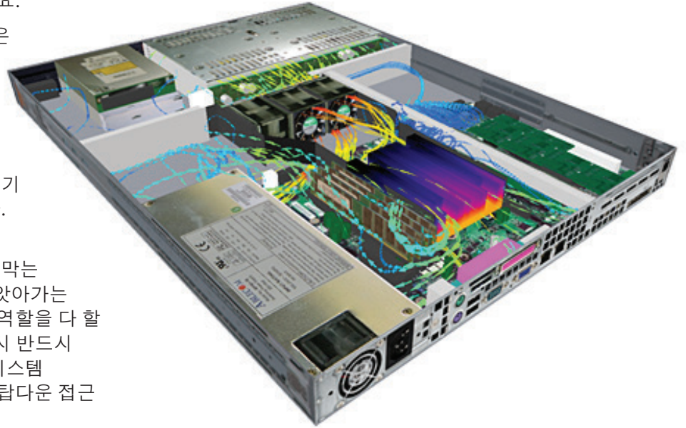
그림 1: Simcenter Flotherm에서 모델링한 1U 서버 내 공기 유동 분포도
