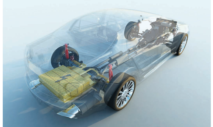
그림 1. 하이브리드 전기차는 차량 내 여러 시스템에 동력을 제공하기 위해 전기와 내연 엔진 모두를 사용합니다.
