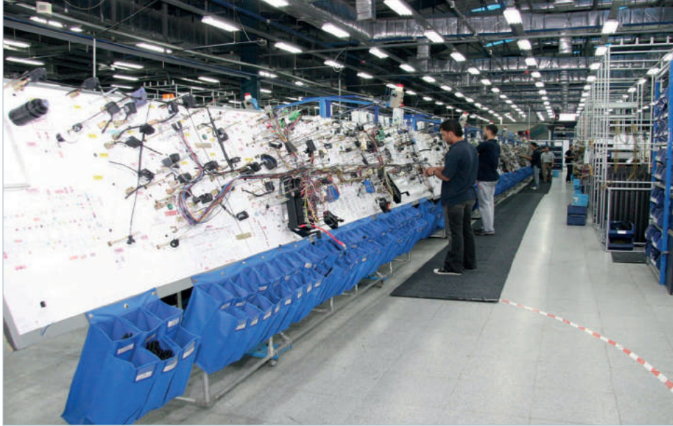
그림 5: 이 폼보드는 제조에 도움이 되는 하네스 전체 도면을 제공합니다
