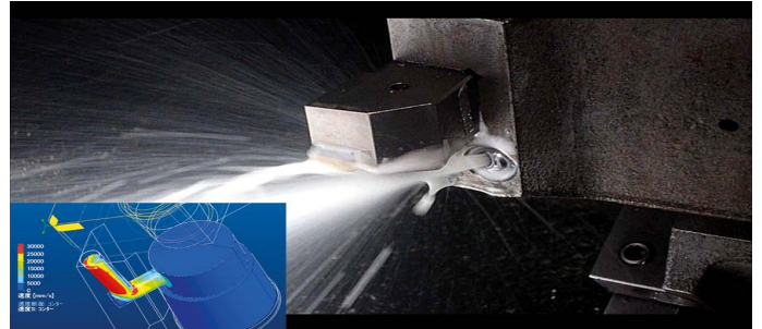
切削工具の液冷ノズル設計に Simcenter FLOEFD を使用した三菱マテリアル
