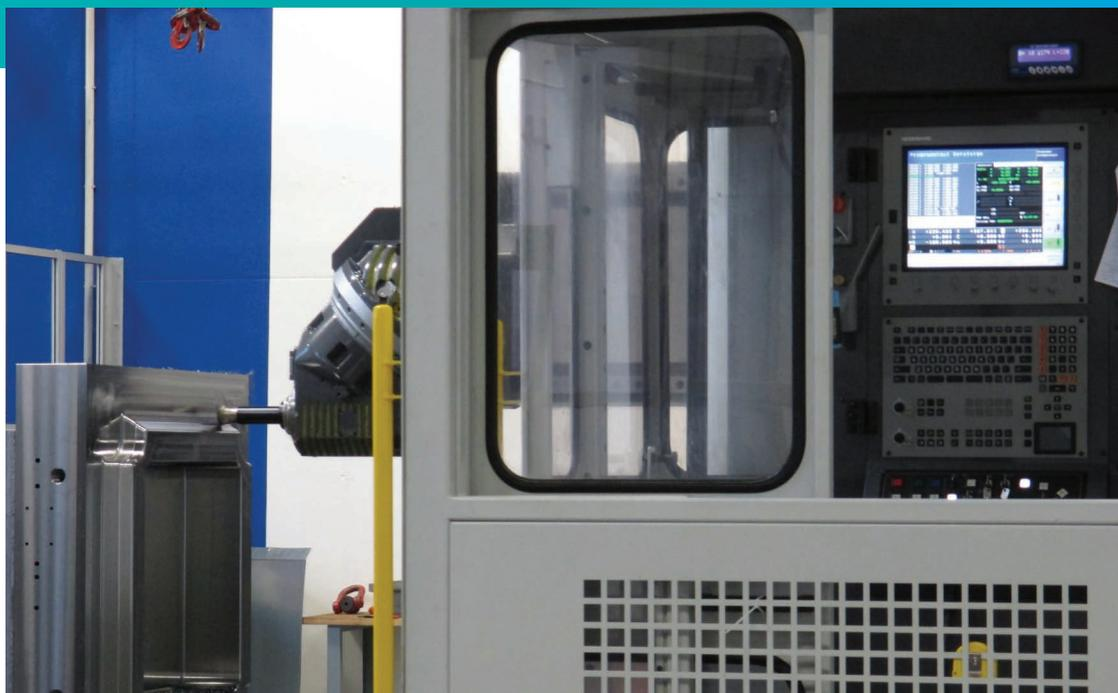
金型製作では、EDMの代わりに、強力な高精度NC 3軸 / 5軸加工機を使った高速金属切削が使用されるようになってきました。
