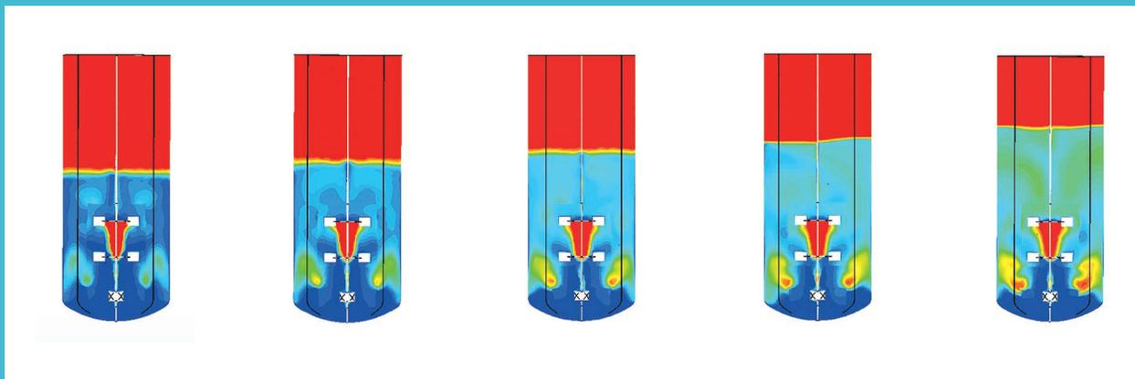
図4 Simcenter STAR-CCM+を使ってガス噴射率を上げる効果を示すミキサーモデル
