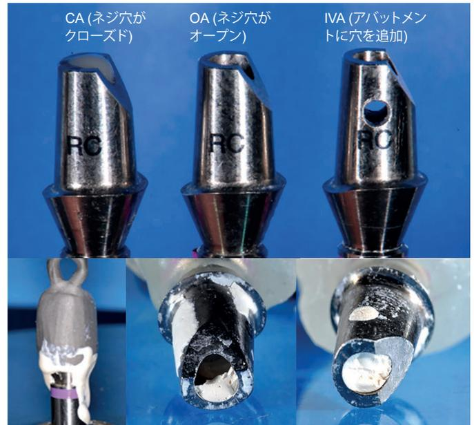
図3 アバットメントの各改良型(上)とそれぞれのセメントの状態(下)
