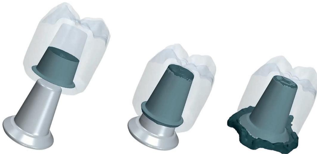
図5 Simcenter STAR-CCM+で生成した3D画像で、CA型アバットメントにクラウンを装着する際のセメントの流れを詳細に示している
