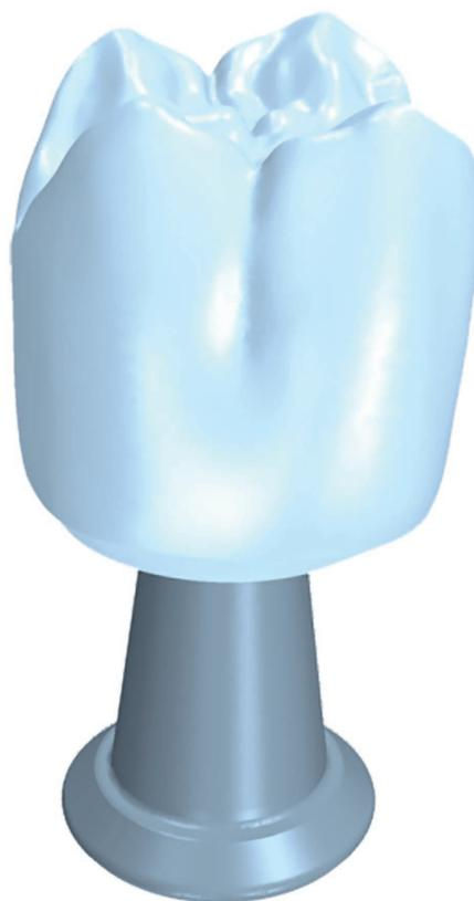
図1 インプラントのアバットメントとクラウンをパラメータ化したモデル
