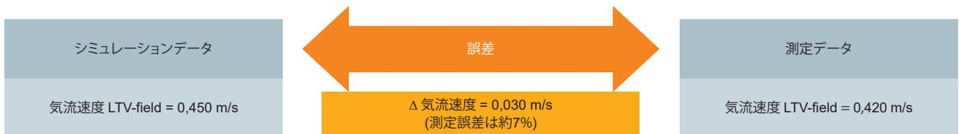
図5 シミュレーションと実測による気流速度の比較
