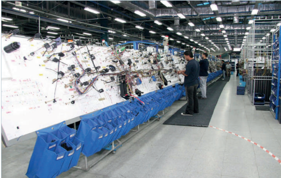
図5: ハーネスのフルスケール図面であるフォームボードは、製造段階にも有用
