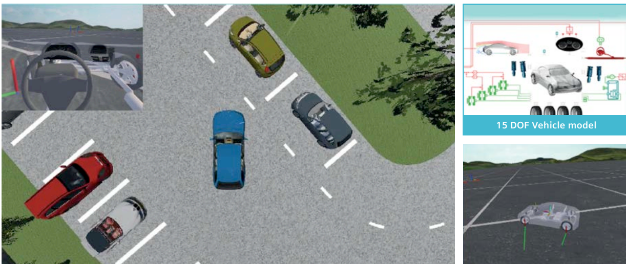
図10: 自動駐車シナリオのSimcenter AmesimとSimcenter Prescanの連成シミュレーション
