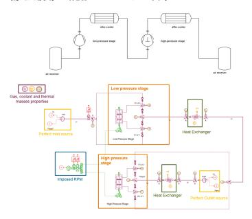
上記のシミュレーションモデルを使用してトルク需要を予測し、気体ラインの動力学特性を理解することができます。それによりポンプ損失 (摩擦、漏れ) を減らし、コンプレッサーのドライブラインの動力学特性 (モーダル形状、周波数応答)を改善してコンプレッサーの性能を高めます。
