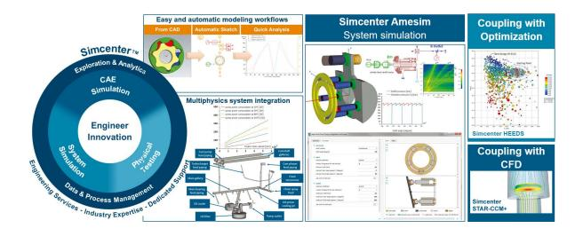
時間領域シミュレーションを補完するSimcenter Amesimの周波数領域ツールを使用すると、自由応答と強制応答を識別して(固有値、自然モード、根軌跡、ボード/ナイキスト/ニコルス線図など)、入力変数(ポンプのリップル励起など)とオブザーバー(回路内の圧力レベルなど)間の伝達関数の振幅や位相を調べることができます。
