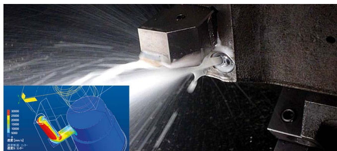
Mitsubishi Materials Corporation utilizza Simcenter FLOEFD per progettare ugelli raffreddati a liquido per utensili da taglio
