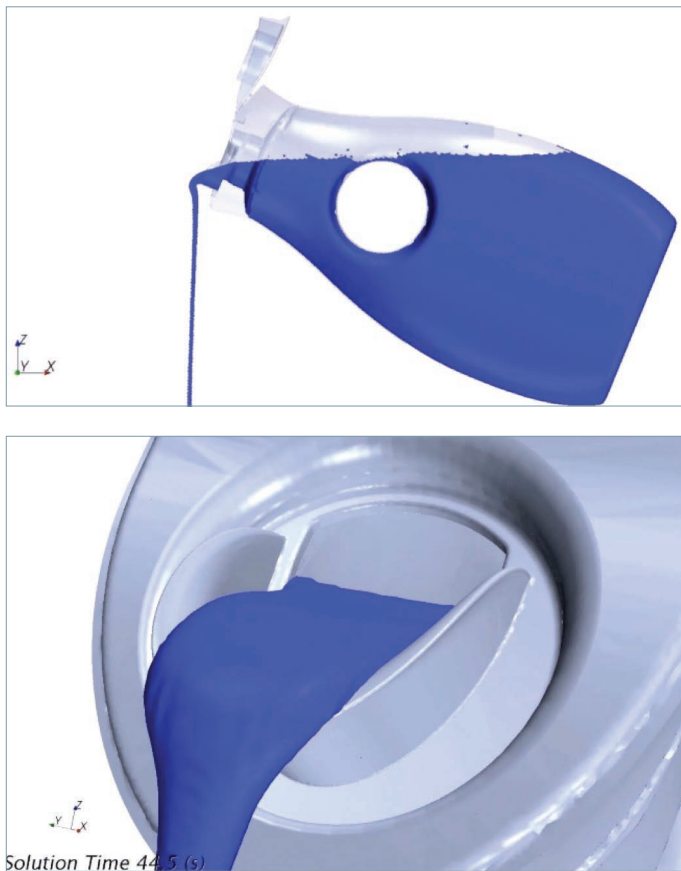
Figura 7: Simcenter STAR-CCM+ che mostra il processo di versamento di una tipica confezione di detersivo per bucato con un primo piano del design del beccuccio.
