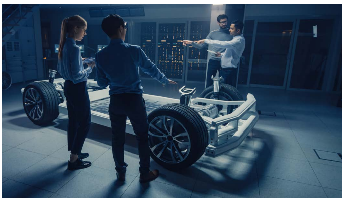
Schéma 2 : Les plateformes dédiées aux VE offrent une plus grande flexibilité de configuration et allongent l'autonomie de conduite en intégrant des batteries plus grandes.
