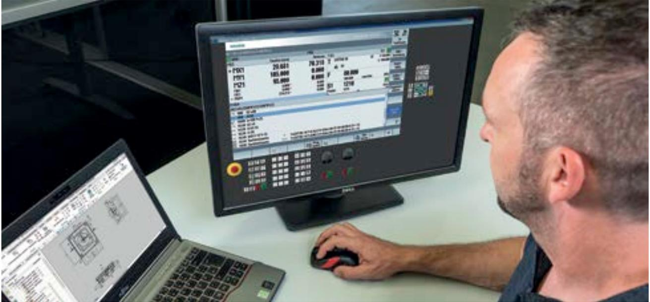
Bereits mit der Basic-Variante können Programme der Demo-Maschinen für 3-achsige Fräs- oder 2-achsige Drehmaschinen – wie in der Vollversion auch – auf entsprechende Bearbeitungszentren übertragen und dort gefertigt werden. Zudem lassen sich sämtliche SINUMERIK Funktionen, die in vielen anderen, komplexen Maschinentypen hilfreich sind, live zeigen und trainieren.
