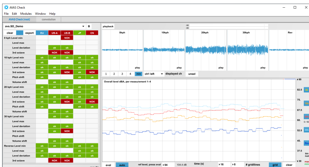
Abbildung 6: Erste Bewertung in Simcenter Testlab Sound Designer zur Überprüfung, ob das erstellte Geräuschmodell die AVAS-Vorgaben erfüllt.
