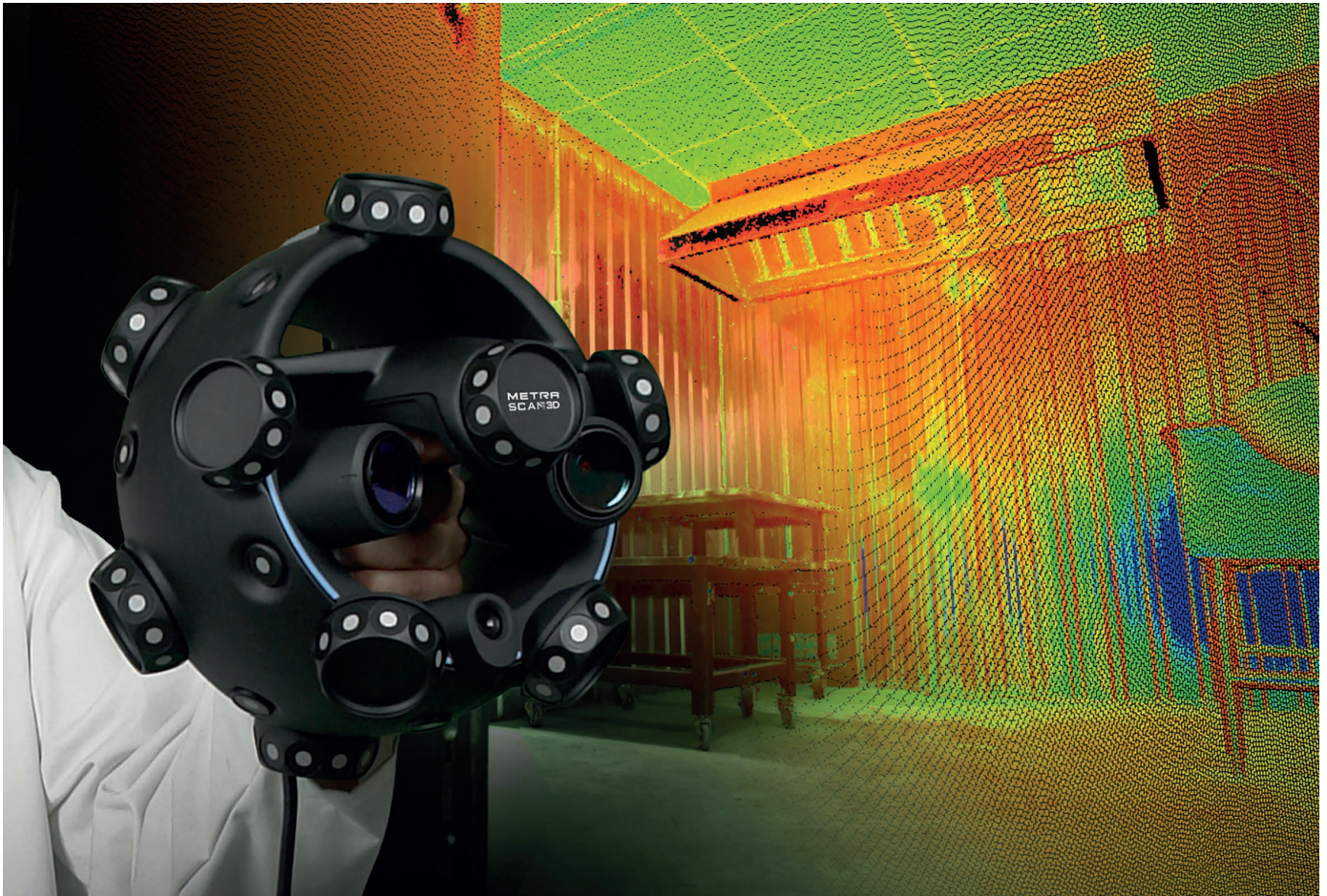
Abbildung 2: Raumsan mit dem tragbaren MetraSCAN von Creaform.
