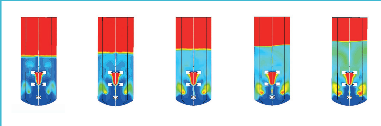
Abbildung 4: Mischermodell, das die in mit Simcenter STAR-CCM+ simulierten Auswirkungen einer Erhöhung der Gasinjektionsrate zeigt.
