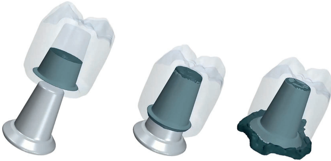
Abbildung 5: In Simcenter STAR-CCM+ erzeugte 3D-Bilder, die die Details des Zementflusses während der Kroneneinpassung beim CA-System zeigen.
