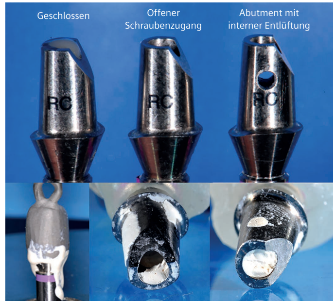
Abbildung 3: Abutmentmodifikationen (oben) und Auswirkungen von Modifikationen auf die Zementretention (unten).
