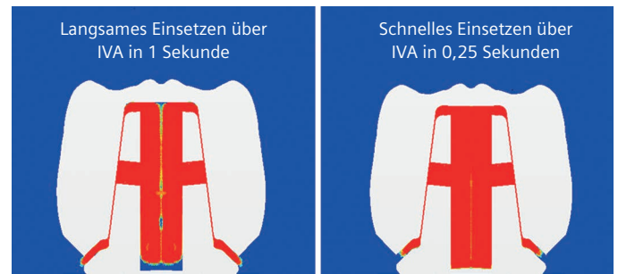
Abbildung 10: Auswirkung der Einpassgeschwindigkeit auf den Zementfluss im IVA-System.
