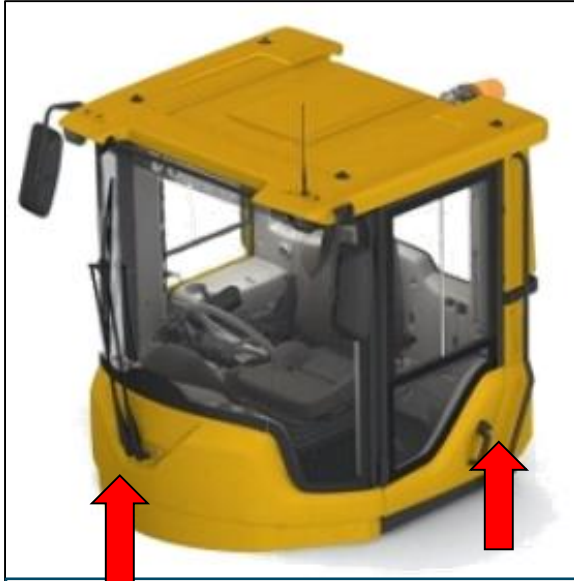
Struktur-eigene Geräusche (Vibrationen werden übertragen und emittieren an anderer Stelle)
