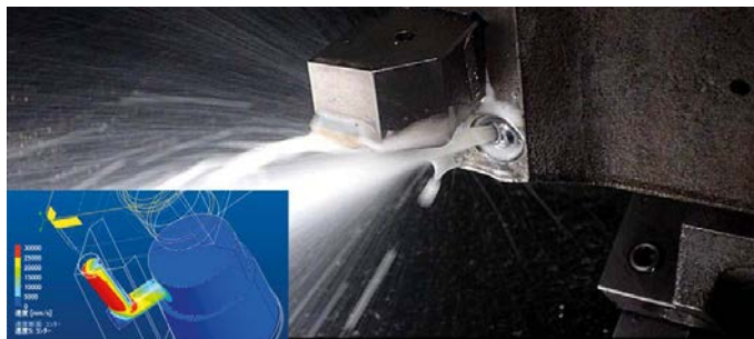
Společnost Mitsubishi materials využívá Simcenter FLOEFD při návrhu kapalinou chlazených trysek pro obráběcí stroje
