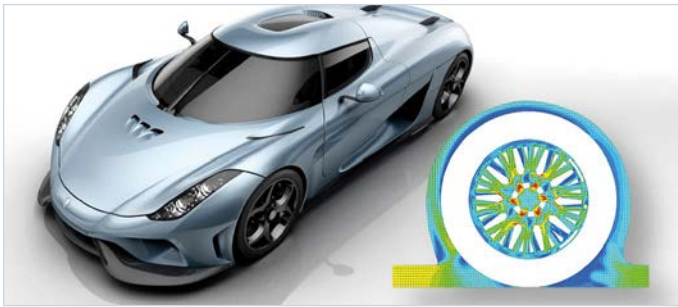
Simulace chlazení brzd sportovního automobilu pomocí funkcí CFD v rámci CAD systému
