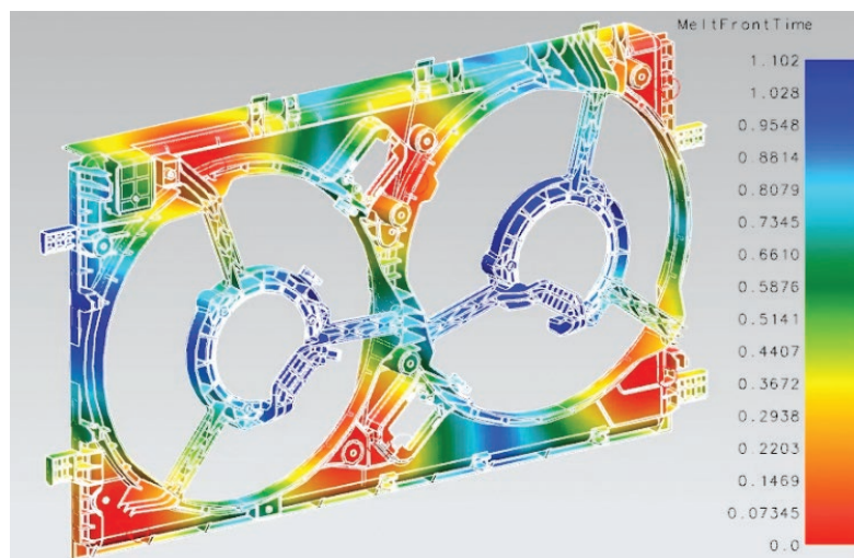
Анализ литья позволяет в кратчайшие сроки выявить недостатки конструкции литых деталей.
