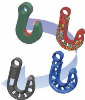
Оптимизация топологии для новой конструкции крюка крана
