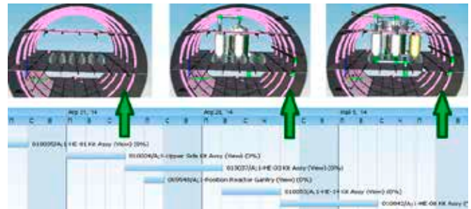
Рис. 2.3.6 Визуализация плана строительства
