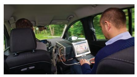
Платформа Simcenter SCADAS включает версии модулей в исполнениях, устойчивых к таким сильным воздействиям окружающей среды, как вода, пыль, экстремальные температуры, удары и вибрации. Благодаря применению универсальных согласующих усилителей эти специализированные системы резко сокращают потребность в оборудовании при проведении испытаний с различными типами датчиков.
