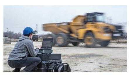
Системы Simcenter SCADAS выдают качественные данные и обеспечивают точную фазовую синхронизацию сигналов с акселерометрами и микрофонами, источниками возбуждения вибрационных и акустических колебаний, передающихся по воздуху или элементам конструкции, что является необходимым при проведении анализа путей передачи колебаний в широком диапазоне частот. Это помогает точно определять эксплуатационные нагрузки и передаточные функции для модального и виброакустического анализа.
