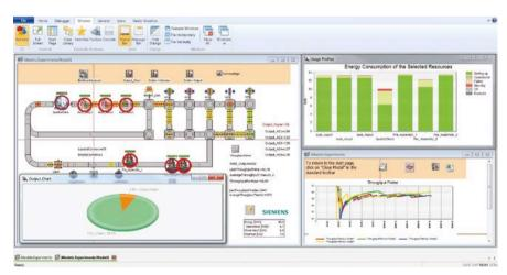
コンテキスト依存のリボンメニューとエネルギー分析ツールにより、システムのエネルギー使用量を 簡単に評価することができます。
