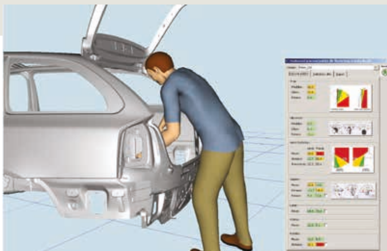
Unikátní ergonomické simulace v Jack human simulation
