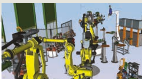
BIW linka simulována v Process Simulate pro virtuální zprovoznění
