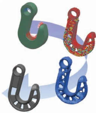
トポロジーの最適化による新しいクレーンフックの設計
