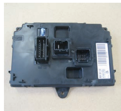
Módulos del proyecto del Peugeot 407. La unidad de control electrónica trasera va colocada debajo de la carrocería, en la parte posterior del vehículo.
