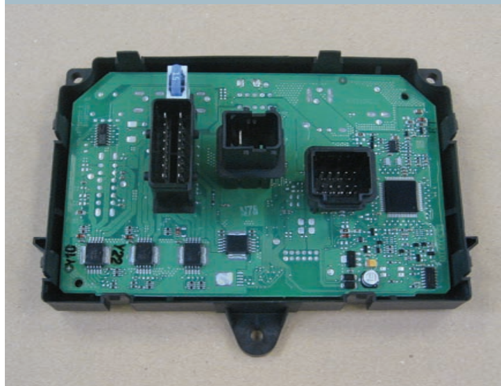
Módulos del proyecto del Peugeot 407. La unidad de control electrónica trasera va colocada debajo de la carrocería, en la parte posterior del vehículo.
