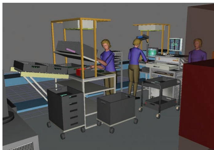
Simulación del área de trabajo para el proyecto de Peugeot realizada por Jack.
