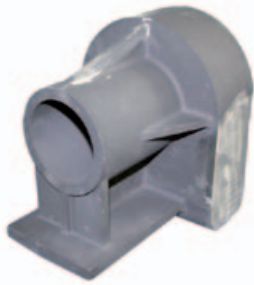
Realer Rohling des simulierten Gussteils
