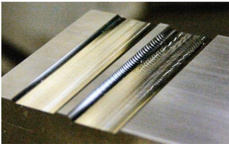
圖 1：兩次切割顯示穩定與震動機械加工條件。
