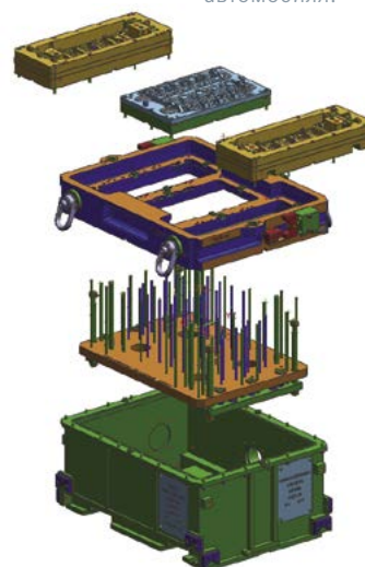
Модели NX песчаных форм для литья и соответствующую оснастка для компонентов двигателя автомобиля.
