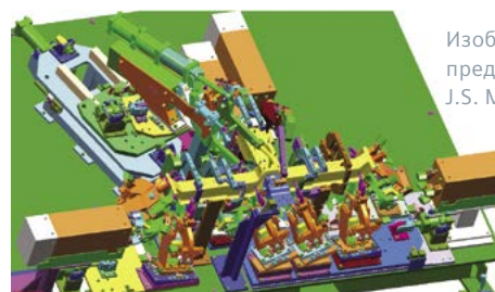
Сварочное приспособление с зажимами и сварочными клещами для сборки автомобиля.
