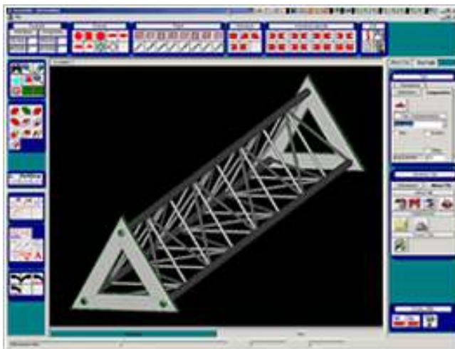
Adigeのマシン・ツールを使用した、製造前の管状部品の設計とアセンブリ
