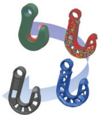
Otimização de topologia para novo projeto de gancho de guindaste
