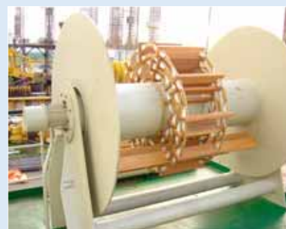
Loodsladder lier voor het aan boord laten van de loods
