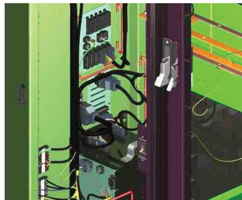
NX Electrical Routingでは、この配電モジュールのように、複雑な製品アセンブリ内にワイヤハーネスのバーチャル・プロトタイプを作成できるため、システムの開発期間を短縮することができます。
