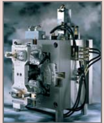
Spritzgusswerkzeug, konstruiert mit dem Mold Wizard.
