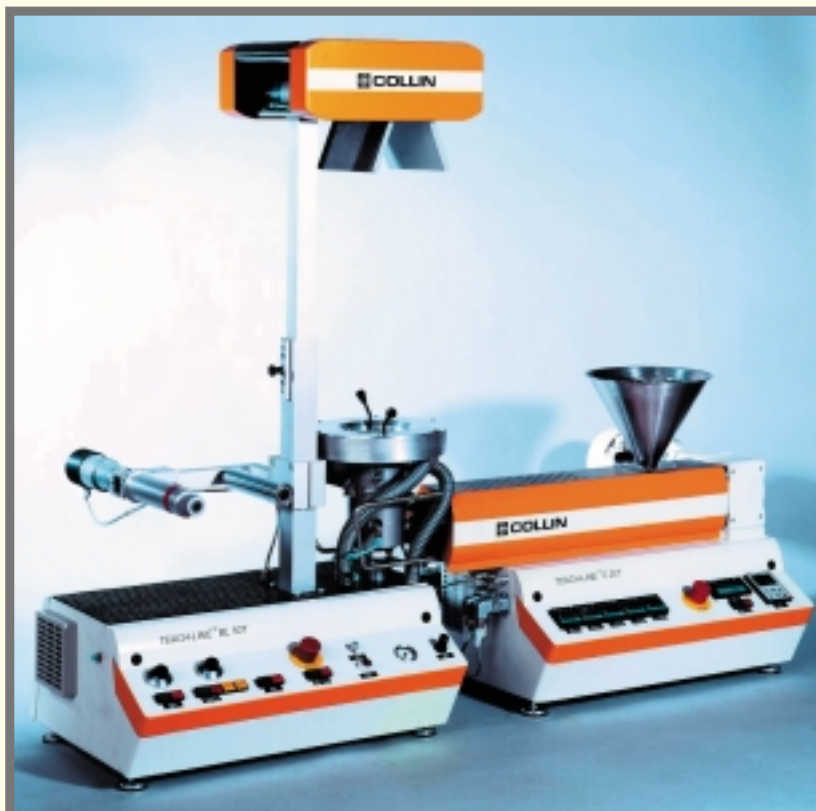
Die komplette Blasfolienanlage BL 30 aus der Reihe Teach-Line entstand mit Solid Edge.
